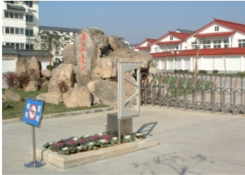
如果是临时来访的车辆，驾驶员进入小区大门前，在入口处领取临时卡，车主取卡后，在读卡机的感应区（感应距离1米内）晃一下，瞬间完成读卡工作，并将卡上信息传至服务器，门卫开启道闸。车辆离开后，道闸关闭。
