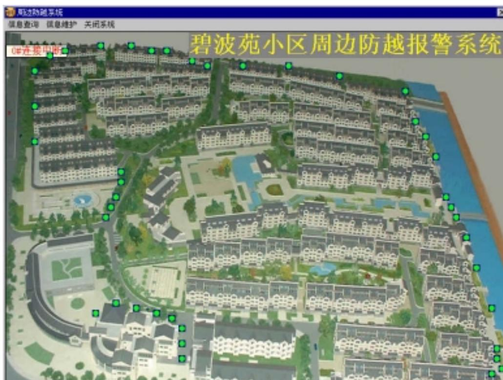
管理中心的周边防越报警系统接收 LON 周边防越控制模块传来的报警信息后，进行分析处理并发出报警，发出声光报警，将报警时间、报警地理位置、报警点探头方位、探头类型，显示于主机的电子地图上。
