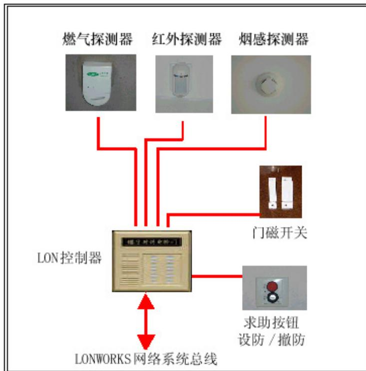
**红外门磁报警：**在容易入侵的大门（或窗户）的位置安装红外线探测器（或玻璃破碎探测器）、门磁开关报警器，当可疑者撬门（开门）或破窗想进入室内时，监控器进入工作状态并发出声光报警信号，同时经 LON 监控模块传送到小区管理中心的 LONWORKS 监控网络系统的监控主机，并在监控主机上显示出所报警的楼宇、单元、楼层、住户的具体位置及户主的基本信息等。
