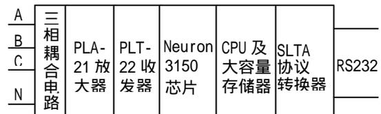
图 3 集中器结构原理图
