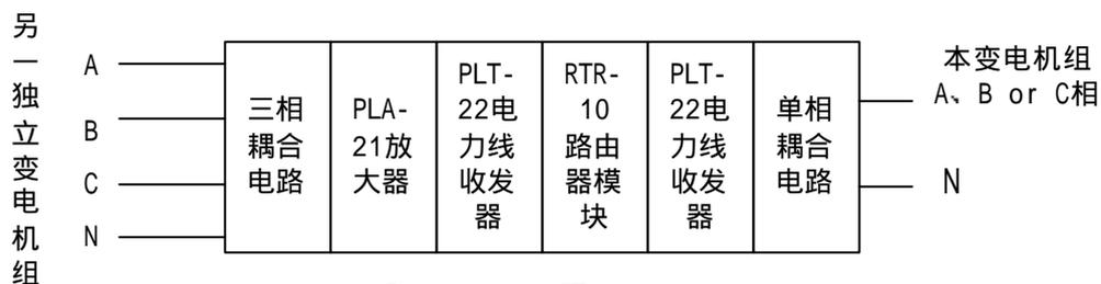
图4 路由器结构原理图
