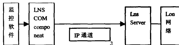
图 1 DCOM 方式结构图
